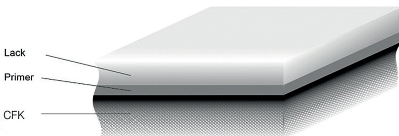
Typischer Aufbau einer Flugzeug-Lackschicht. Die Schichtdicke hat Einfluss auf Gewicht, Blitzschutz, UV-Beständigkeit und Korrosionsschutz. © Micro-epsilon
