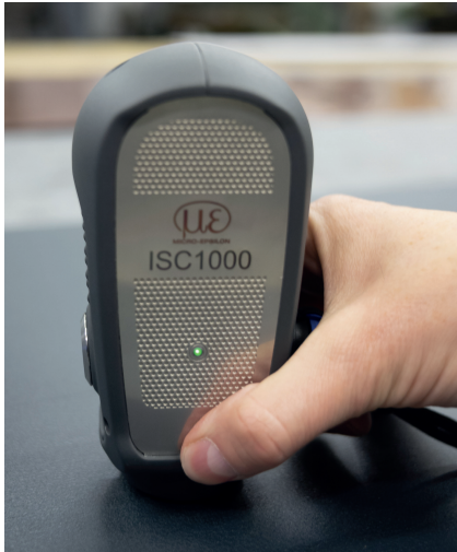
Das ISC1000 misst auf Mikrowellenbasis die Gesamtschichtdicke isolierender Materialien auf CFK und Metallsubstraten zerstörungsfrei und ohne Koppelmedium. © Micro-epsilon
